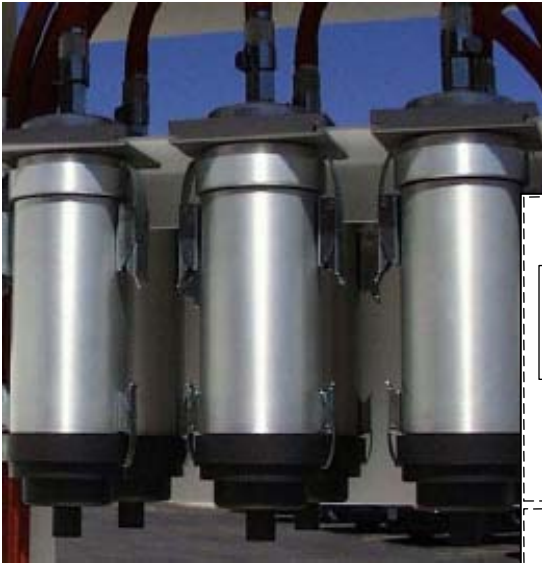
Cartouches ChemComb installées dans un préleveur Partisol Spéciation
