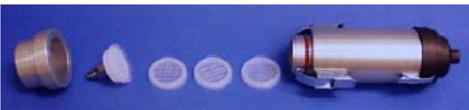
ChemComb ouvert montrant la section Dénudeur (en haut) et Filter Pack (en bas)
