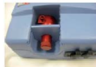
Cyclone PM-10 installé dans l'analyseur
