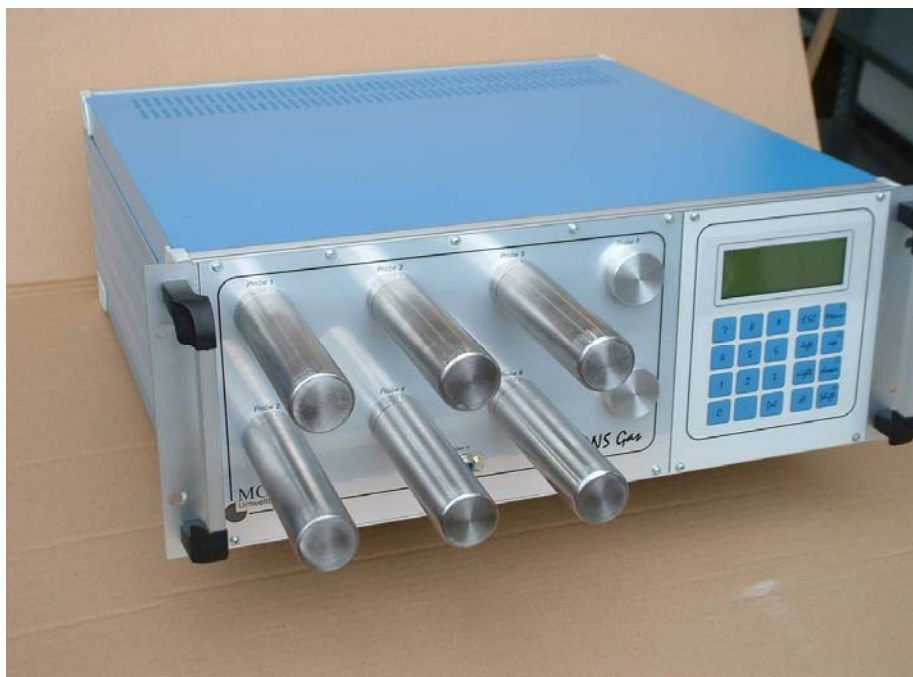
Micro PNS avec 6 voies installées en face avant
