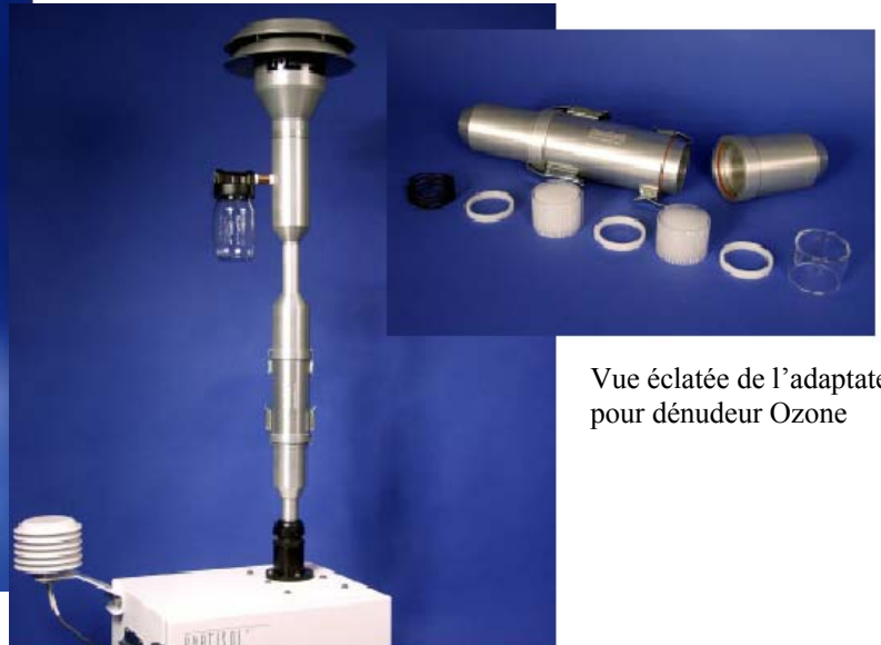
Montage du dénudeur Ozone sur la ligne du préleveur
