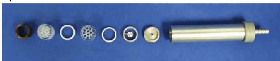
Composants du Mini PEMS inorganique (de gauche à droite) : ressort, dénudeur, joint, dénudeur, joint, impacteur, cartouche avec porte filtre 14,5 mm
