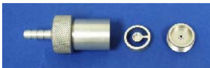
Composants du Mini PEMS inorganique (de gauche à droite) : ressort, dénudeur, joint, dénudeur, joint, impacteur, cartouche avec porte filtre 14,5 mm
