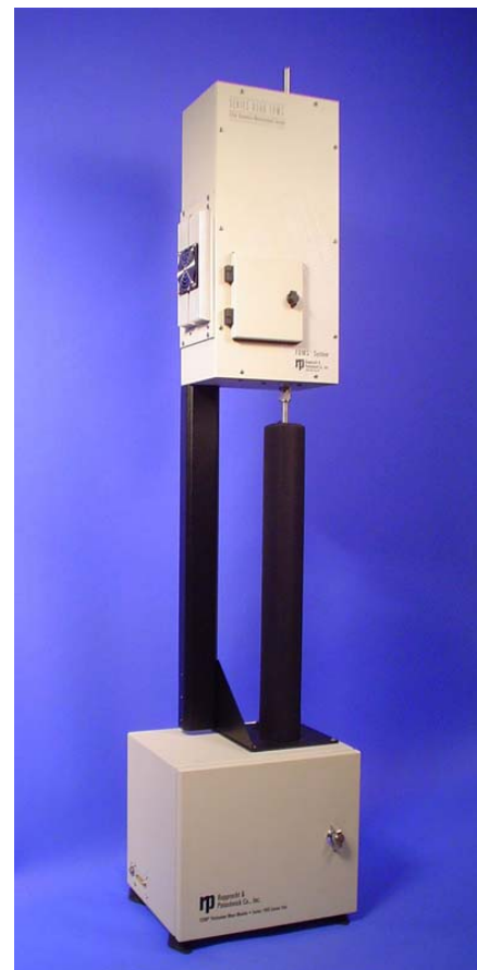
Figure 1 : module TEOM FDMS installé sur un TEOM 1400 AB
